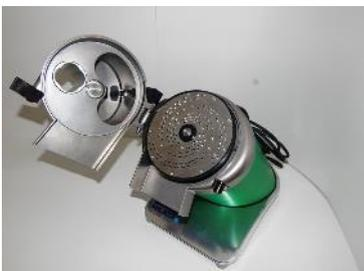
Setzen Sie die Scheibe nun auf die Antriebswelle. Durch eine leichte Drehung rastet die Scheibe in den Mitnehmerstift an der Antriebswelle ein, nun sitzt die Scheibe korrekt! „oben bündig mit der Antriebswelle“. Damit die Messerscheibe richtig platziert werden kann, muss die Nabe und der Mitnehmerstift sauber sein.
