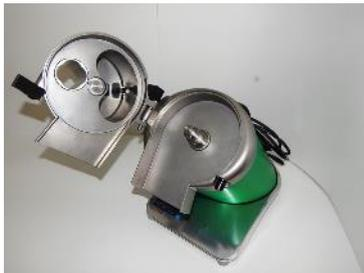
Um eine Schneidscheibe einlegen zu können, wird zuerst der Verschlusshebel geöffnet und der Aufsatzkopf nach links geschwenkt.
