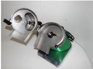
Bevor eine Scheibe eingesetzt wird, muss der Auswerfer oder Auswurfteiler montiert werden, korrekt eingesetzt berührt dieser beinahe den Boden des Schneideraums. Ohne Ausräumer/ Auswurfteiler staut sich das Schnittgut unterhalb der Schneidescheibe, die Scheibe wird nach oben gedrückt und zerkratzt den Schneidekopf und die Messer sind beschädigt.
