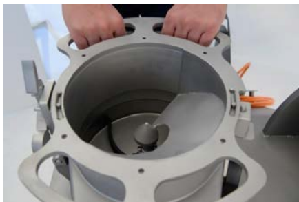
Fig. 28: Ailette de vis installée
