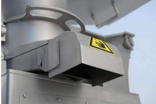
Abb. 35: Abdeckung auf Auslauf montiert
