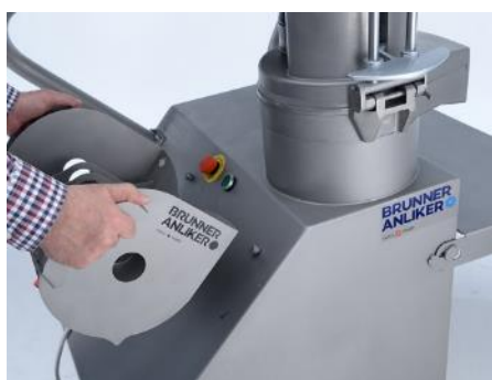
Fig. 43: Montage du support de disque de coupe sur les supports déjà existants sur la machine.
