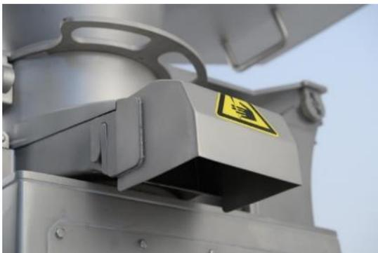
**Abb. 31:** Abdeckung auf Auslauf montiert
