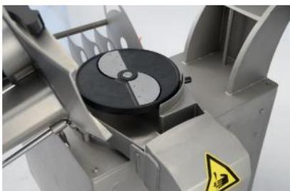
**Abb. 24:** Einfüllwanne und Aufsatzkopf weggeschwenkt
