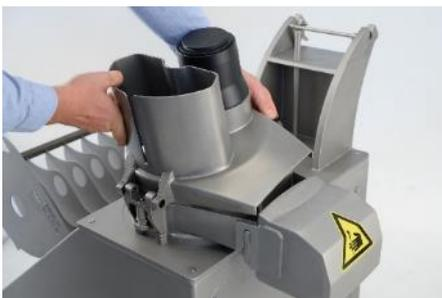
Abb. 27: Aufsatzkopf verschliessen
