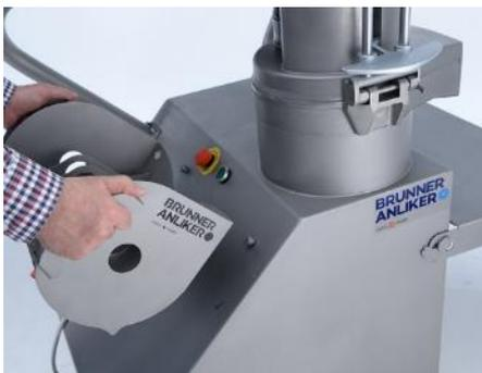
Am Gemüseschneider GSM wird der Schneidscheibenhalter an den beiden Haken unterhalb des NOT-AUS-Tasters eingehängt.
