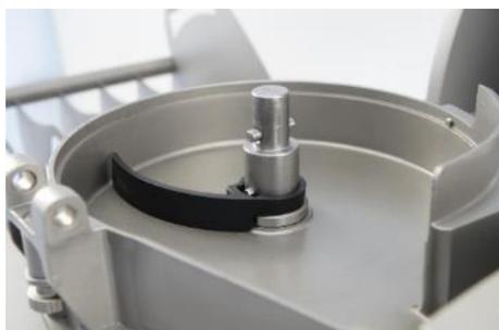
Vor dem Einsetzen der Schneidscheibe muss der Auswerfer oder Auswurfteiler montiert werden. Er sitzt korrekt, wenn er beinahe den Boden des Schneideraums berührt. Ohne Auswerfer / Auswurfteiler staut sich das Schnittgut unterhalb der Schneidscheibe, die Schneidscheibe wird nach oben gedrückt und zerkratzt so womöglich den Schneidekopf und beschädigt die Messer.
