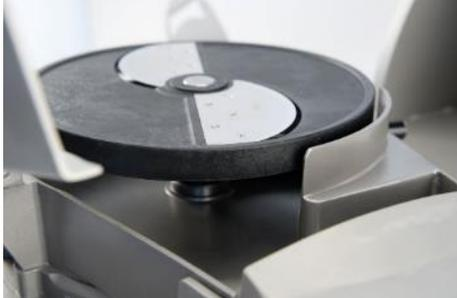
Abb. 26: Schneidscheibe eingesetzt
