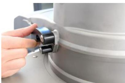
Abb. 15: Aufsatzkopf verriegeln
