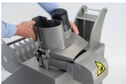
Abb. 14: Aufsatzkopf einsetzen
