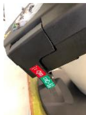
Abb. 12 Verschlusshebel On/Off Schalter
