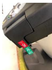
Fig. 12 : Interrupteur On/Off du verrou
