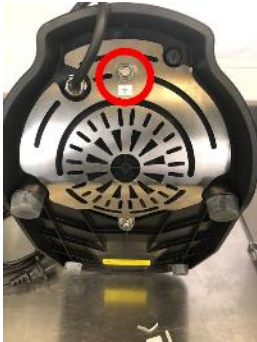
Fig. 17 : Connexion au conducteur d'équipotentialité
