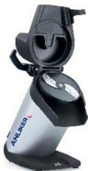
Enfilez le disque sur l'arbre moteur. Tournez légèrement pour que le disque s'enclenche sur la clavette d'entraînement de l'arbre moteur et soit correctement aligné (faire attention à ce qu'il ne dépasse pas de l'arbre moteur).
