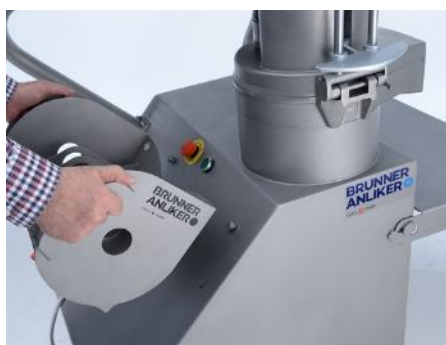
Fig. 30 : Montage du support de disque de coupe sur les réceptions existantes de la machine..
