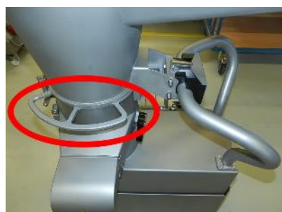
Fig. 26 : Déplacer l'aillette de vis
