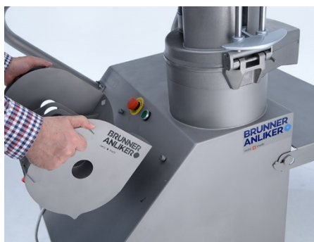
Abb. 37: Montage des Schneidscheibenhalter.
