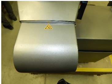
Abb. 31: Abdeckung auf dem Auslauf montiert
