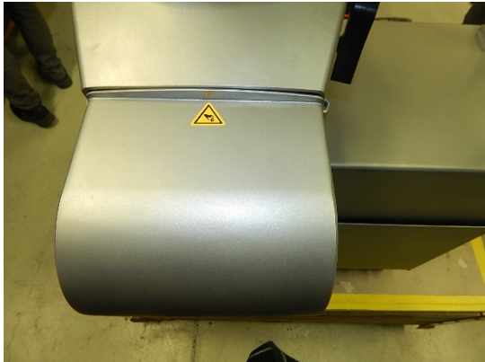
Abb. 28: Abdeckung auf Auslauf montiert
