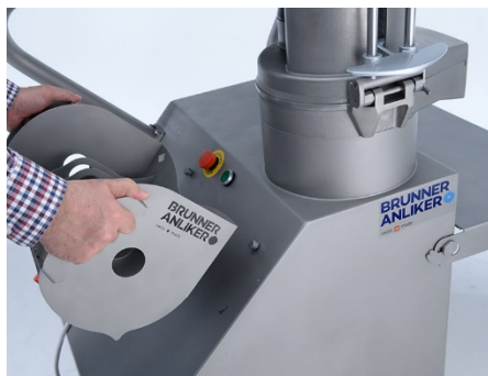
Abb. 32: Montage des Schneidscheibenhalters an den bereits vorhandenen Aufnahmen an der Maschine.
